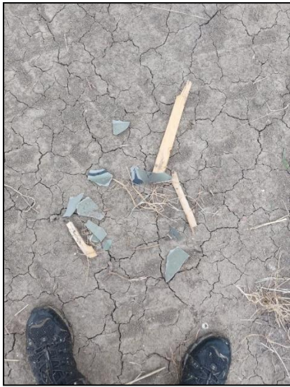
Figuur 2. Schade aan behuizing cameraval.
