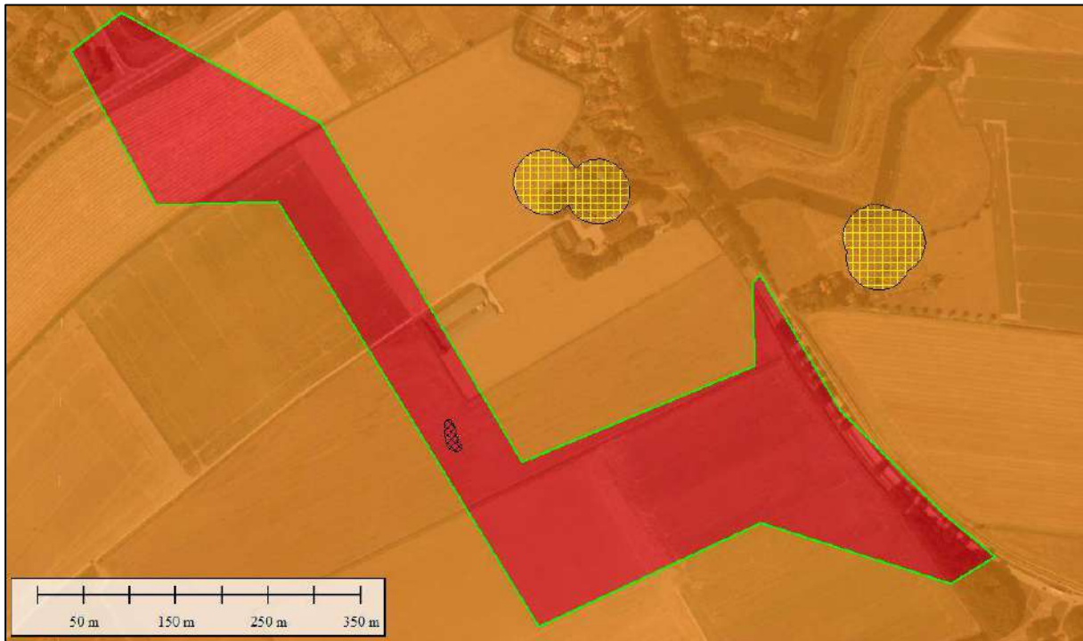
Figuur 21. Het opsporingsgebied (rood) en het verdachte gebied (oranje) verschoten geschutmunitie. In zwart (arcering) is het opsporingsgebied klein-kalibermunitie, hand- en geweergrenaten weergegeven. De verdachte gebieden achtergelaten geschutmunitie (geel) zijn niet van invloed op het projectgebied. Bron satellietbeeld: World Imagery.
